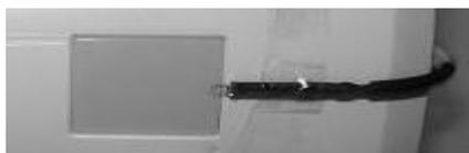
Рекомендуемое расстояние между светодиодом излучателя и окном фотоприемника 0...10 см.
