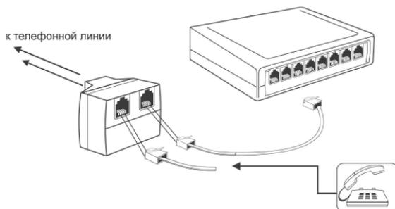
Рисунок 7.3 Использование телефонного разветвителя.
