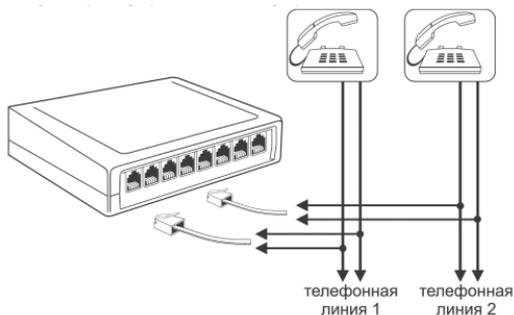
Рисунок 7.1. Подключение адаптера к телефонной линии.
