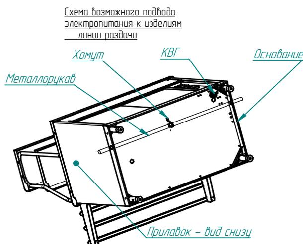
В основаниях изделий линии раздачи введено сквозное отверстие диаметром 29,5 мм и поддерживающие хомуты для возможности проведения металлорукава с питающими кабелями сквозь все изделия линии раздачи.
