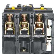
Насечки на присоединительных контактах снижают нагрев проводов благодаря надежной фиксации в местах присоединения и увеличению суммарной площади контакта.
