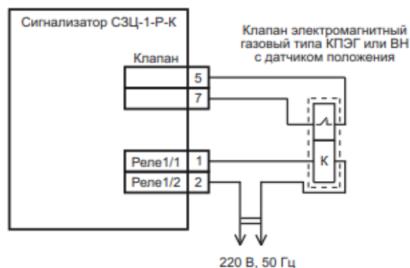
Соединение сигнализаторов СЗЦ-...-Р-С в шлейф с применением запорного клапана на 220 В
