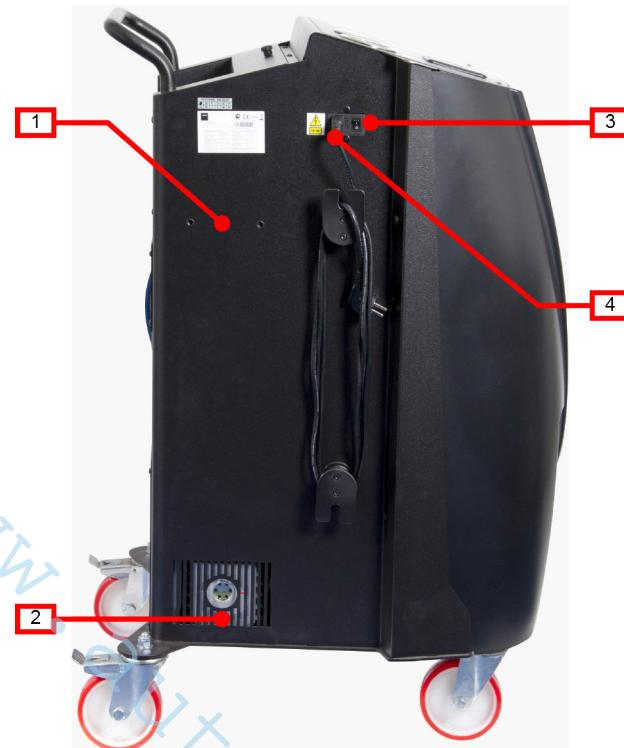
1. Крепежные отверстия для комплекта промывки
