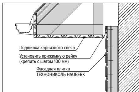
Рис. 9.1. Монтаж верхнего ряда под карнизным свесом. Вариант 1
