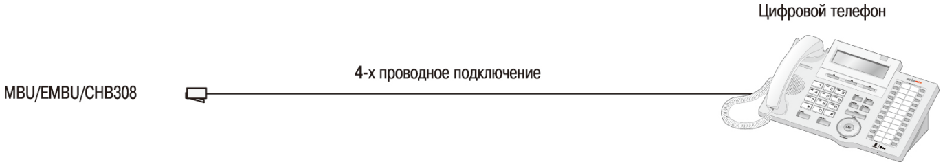
Рис. 2.21 Подключение цифрового аппарата и консоли DSS
