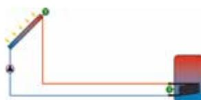
Внутренний теплообменник, система управления насосом
