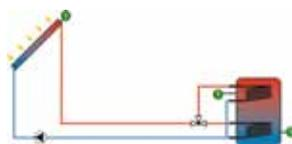
Внутренний теплообменник, зона загрузки, логический клапан (1 x E13170 дополнительно требуется)
