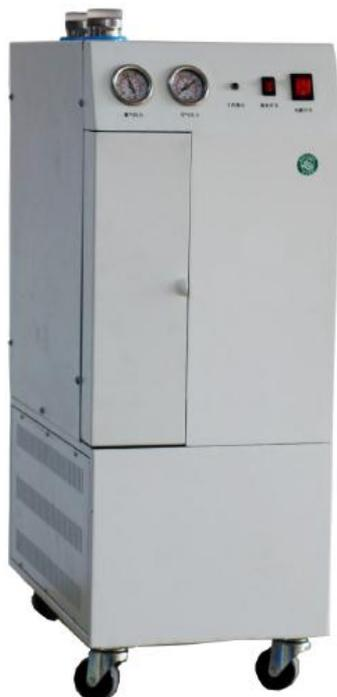
Генераторы азота серии QL используют технологию адсорбции при переменном давлении (PSA) для производства сверхчистого азота. Сжатый воздух высушивается и фильтруется через конденсаторные трубки и фильтры. Большинство O<sub>2</sub>, CO<sub>2</sub>, влаги, углеводородов будут удалены после прохождения газа через CMS цилиндр в модели очистки. Будет генерироваться чистый, сухой и сверхчистый азот.
