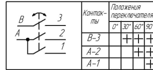
Схема коммутации переключателя SA1
