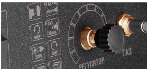
Регулировка мощности изменением подачи газа
