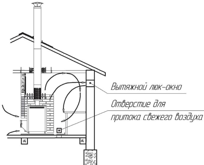
Рис. 5 Схема воздухообмена в парилке
