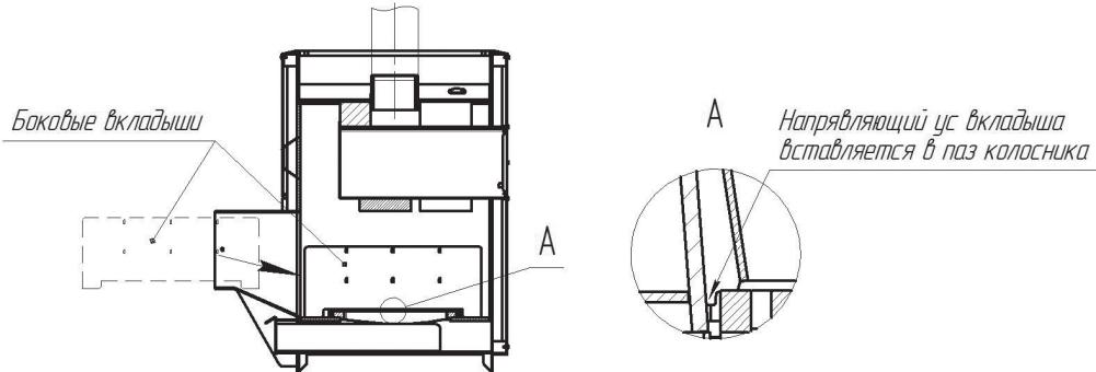
Рис.6 а. Установка боковых вкладышей под уголь в топку печи
