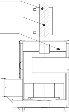
Рис. 7 Схема прочистки печи.
