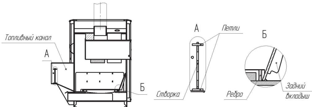
**Рис. 6 6. Установка заднего вкладыша под уголь и створки в топку печи**
