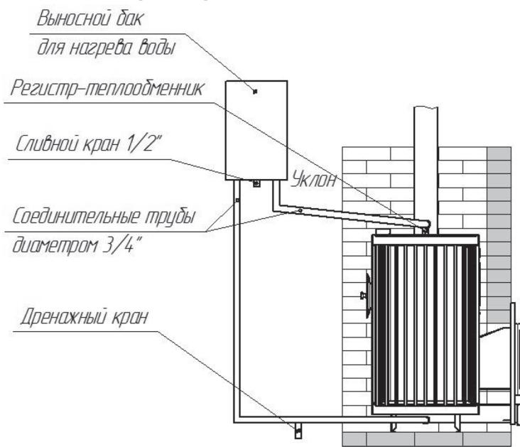
**Рисунок 8. Подключение бака с встроенным регистром**
