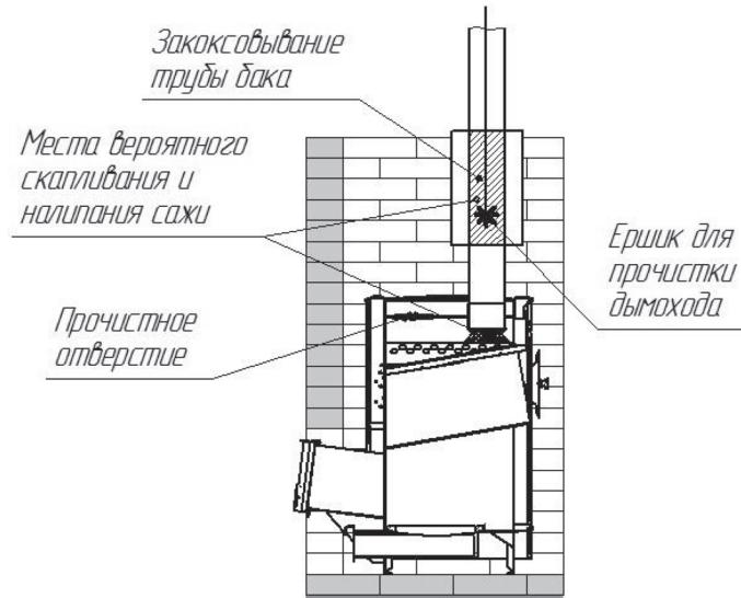
Рисунок 14. Схема прочистки печи
