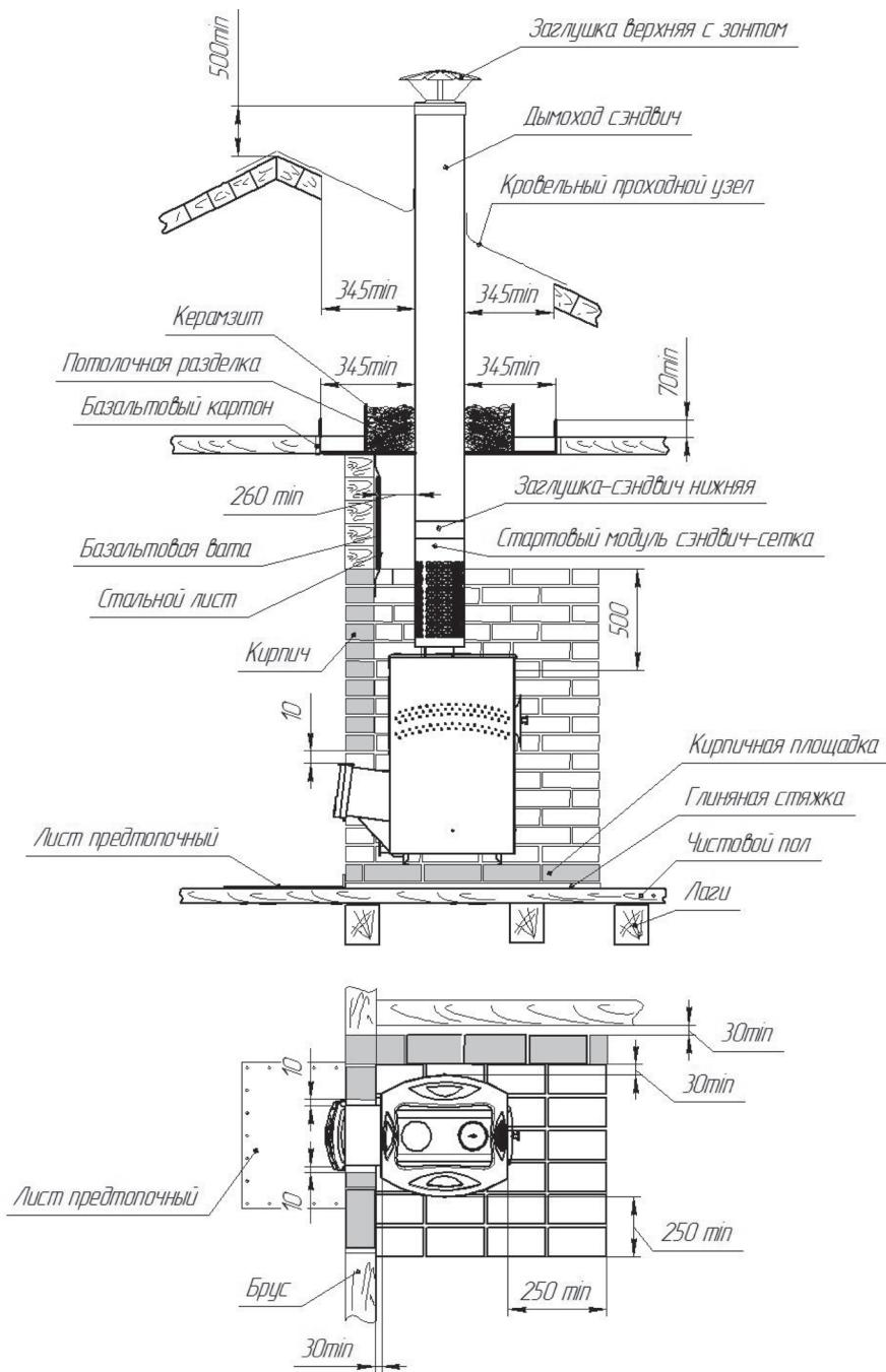
Рисунок 11 Схема установки печи с кирпичной кладкой
