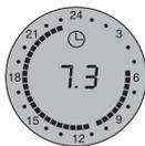
После программирования регулятор готов к ежедневной работе. Вращая ручку влево-вправо можно уменьшать-увеличивать температуру, а последовательно нажимая кнопку - переключать в режимы работы "с Таймером" или "без Таймера" (см. стр. 12).
