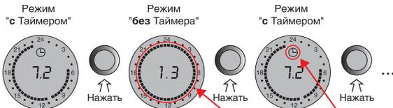
Признаками режима работы "без Таймера" служат отсутствие символа ⌚ таймера и полностью "черная" окружность дисплея. Для режима "с Таймером" символ таймера ⌚ присутствует на дисплее.
