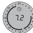
Такая индикация температуры в "условных единицах" связана с тем, что датчик температуры пола может устанавливаться на различной глубине, и покрытие пола может отличаться теплопроводностью, например, керамическая плитка или ковролин. Ориентировочно можно считать, что одна "условная единица" соответствует 5°C. Температура поверхности пола подбирается пользователем на уровне 26-29°C. На терморегуляторе пользователь обычно подбирает значение на уровне от 6 до 8 единиц.
