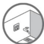
В помещениях с повышенной влажностью размещайте терморегулятор в соответствии с местными нормами по классам защиты IP.
