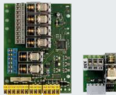
Плата расширения для блоков управления: БК 150 FU E-1 (E FU H) АК 500 FUE-1 (E FU H)
