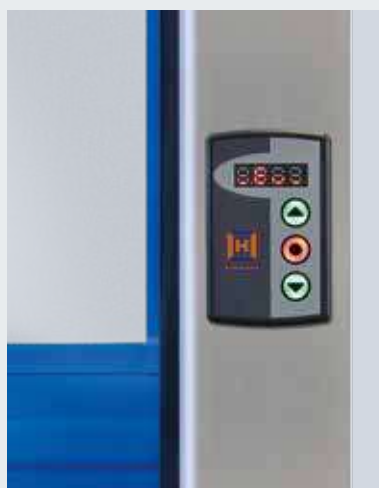
Удобное управление Опциональный элемент управления (80 × 120 мм) для встраивания в боковую направляющую на высоте 1300 мм
