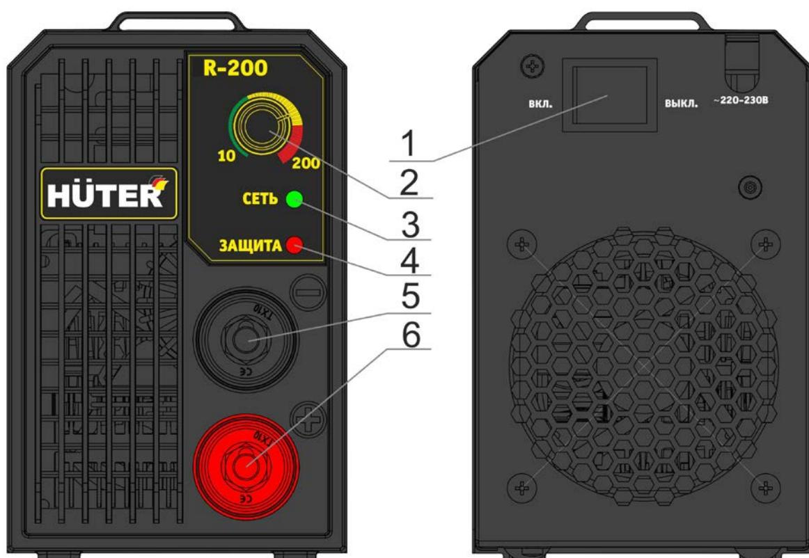
Принцип работы сварочного аппарата заключается в преобразовании переменного напряжения сети частотой 50Гц в постоянное напряжение величиной в 400В, которое преобразуется в высокочастотное модулированное напряжение и выпрямляется. Для регулирования сварочного тока используется широтно-импульсная модуляция высокочастотного напряжения.
