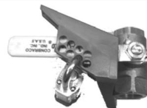
4. Навесить замок в отверстие, максимально плотно фиксирующее рычаг вентиля и заблокировать
