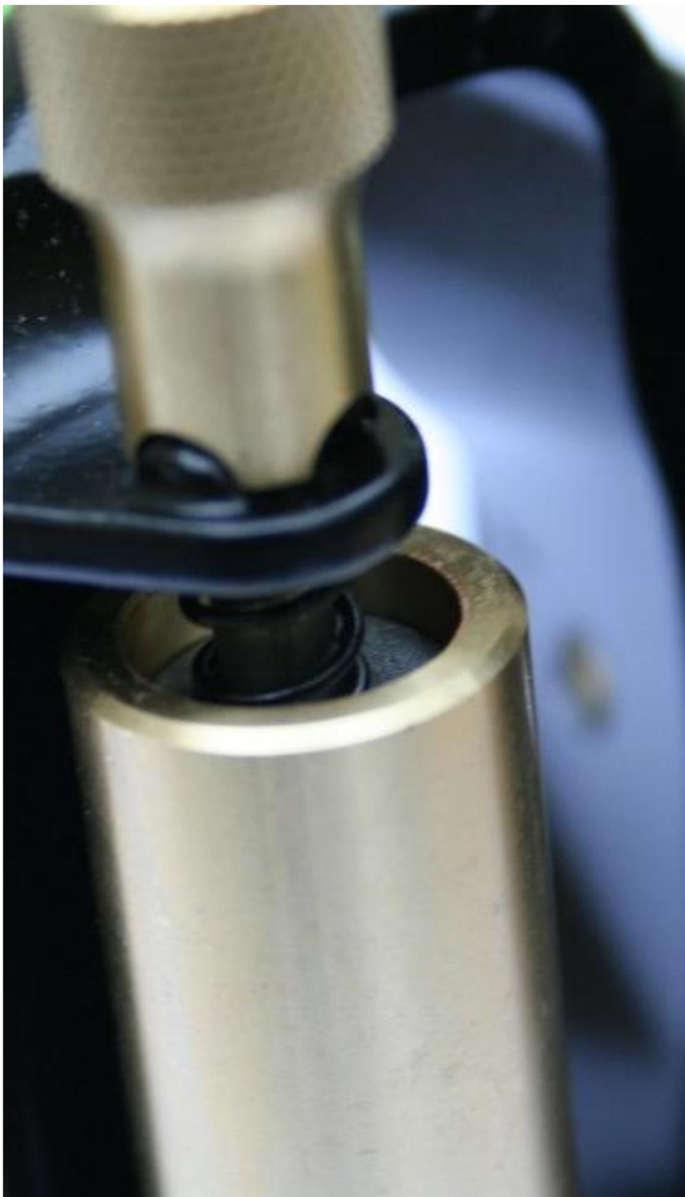
Надо только проверить перед началом заточки, как установлен указатель. Он должен смотреть вверх.
