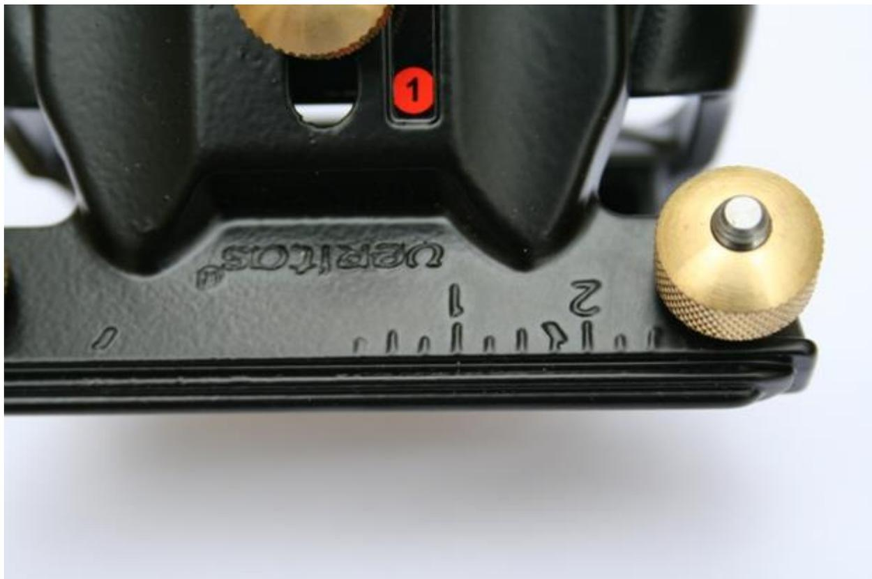
Затачиваемое лезвие может фиксироваться в 3х положениях, в зависимости от требуемого угла заточки. Положения обозначаются цифрами и цветом.
