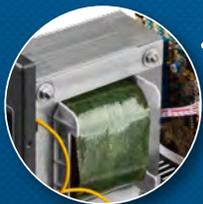
Тонкие стальные пластины сердечника уменьшают вихревые токи и снижают нагрев
