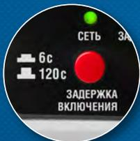
Два режима задержки включения
