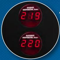
Одновременное отображение входного и выходного напряжения
