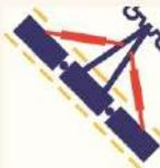
**Равномерное заглубление:** крылья всегда параллельны благодаря опорно-рычажной системе фиксации крыльев.
