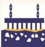
Большое количество точек соприкосновения рабочего органа с землей обеспечивает **равномерное дробление комков**;
