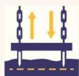
Регулировка соединительными цепями дает **одинаковую глубину обработки** передними и задними зубьями;
