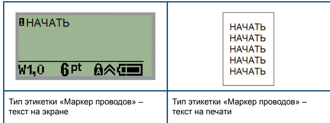
Рис. 6 • Повторяющиеся данные на этикетках типа «Маркер проводов»
