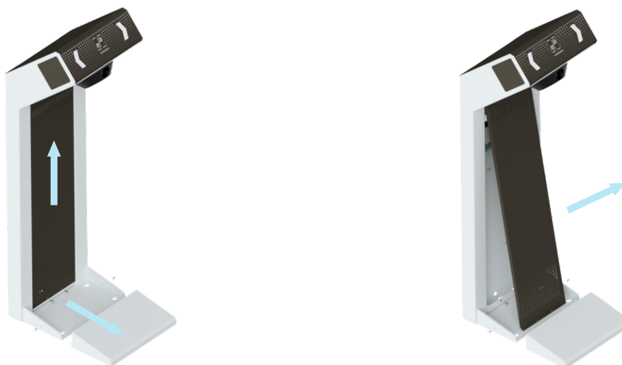
Рисунок 15 – Разборка кожухов турникета
