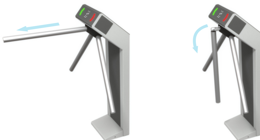
Рисунок 11 – Принцип работы планок «Антипаника»
