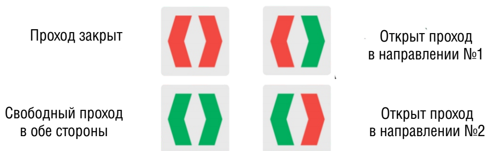
Рисунок 8 – Режимы индикации турникета
