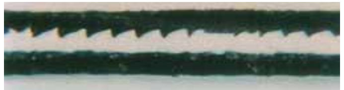
Сварено при помощи насадки с щеткой прочность сварного шва выше на 25%. Предназначено в основном для материала ТПО.
