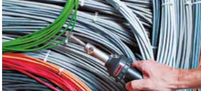
Установка термоусадочной муфты с помощью HOT JET S, оснащенного насаживаемой решетчатой рефлекторной насадкой.
