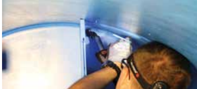
WELDING PEN R в сочетании с угловыми насадками делают сварку возможной даже в очень узких местах.
