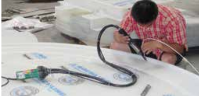
Вентилятор MINOR в качестве источника воздуха для DIODE PID
