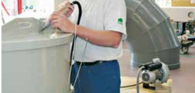
Вентилятор ROBUST в качестве внешнего источника воздуха для WELDING PEN.
