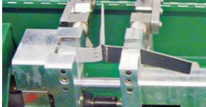
Испытание сварного шва при помощи EXAMO USB.
