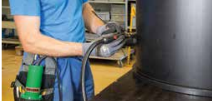
Аппарат LABOR S в сочетании с вентилятором MINOR в качестве внешнего источника подачи воздуха.
