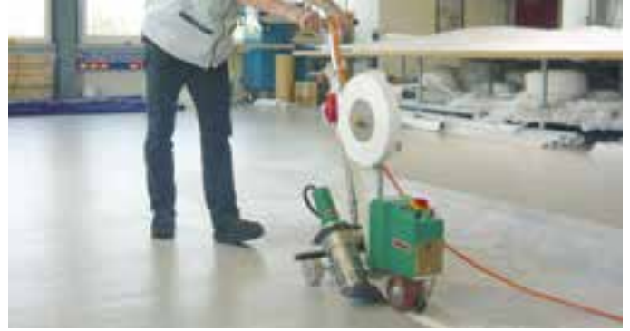
Сваривание ленты с максимальной скоростью.
