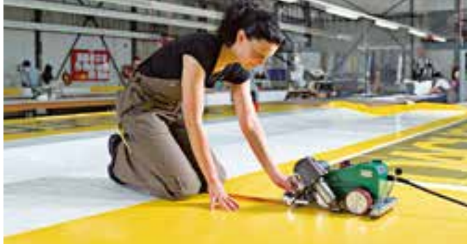
Удобный аппарат для точной сварки: UNIPLAN E.
