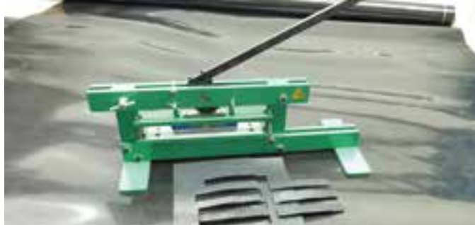
Заготовка универсального размера, быстро изготавливаемая инструментом для вырезания образца COUPON CUTTER
