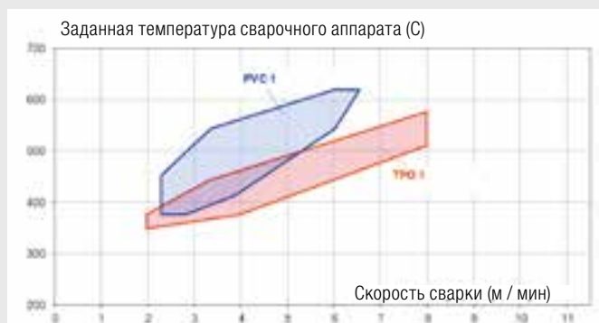
Типичный диапазон сварки для ТПО и ПВХ
