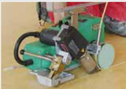
Шаг 2: Сварка прутком с помощью аппарата UNIFLOOR E.
