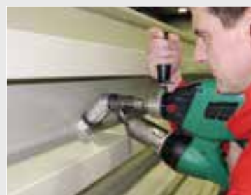
Угловая насадка 45° для WELDPLAST S2 облегчает сварку в труднодоступных местах (принадлежность)
