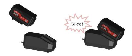
Для отключения аккумулятора от зарядного устройства: необходимо нажать на красную кнопку и сдвинуть аккумулятор вверх.
