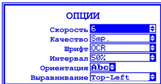
**Скорость** : регулировка скорости двигателя
