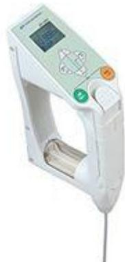
ASTM D7777 - 13 Стандартный метод определения плотности, относительной плотности или плотности API жидкой нефти с помощью портативного цифрового измерителя плотности.
