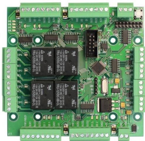
Модуль ST-NB441D предназначен для увеличения емкости контроллера на 4 двери, при этом контроллер ST-NC441 поддерживает подключение до 8 таких модулей. 4 порта модуля предназначены для подключения любых считывателей со стандартными интерфейсами Wiegand 26, Wiegand 34 или пользовательским Wiegand 26–64.
