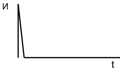
ЗТМ с использованием одного ПЭП
