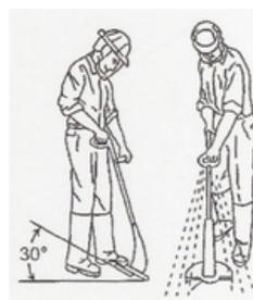
8.2.4. При скашивании высокой травы триммер может перегреться и выйти из строя. Разделите процесс кошения на не сколько этапов, постепенно снижая уровень покоса травы.
