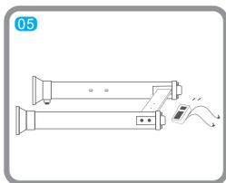
**05** Аккуратно соедините перекладину с двумя антенными панелями и затяните крепежные винты.
