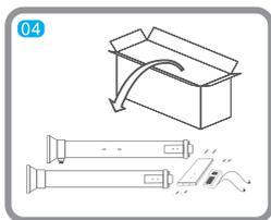
**04** Извлеките антенные панели и электронный блок. Подготовьте перекладину, крепежные винты и силовой кабель.
