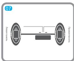
**07** Подключите кабели от электронного блока к обеим панелям и подключите шнур электропитания к одной из панелей.
