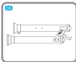
**06** Закрепите электронный блок на перекладине и затяните винты.
