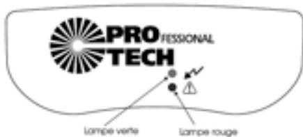
Rysunek 15 – PROFESSIONAL TECH: wskaźniki świetlne
