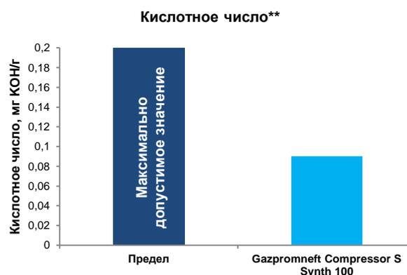
Низкое кислотное число Gazpromneft Compressor S Synth демонстрирует высокую степень очистки базовых компонентов и их высокую стабильность против окисления.
