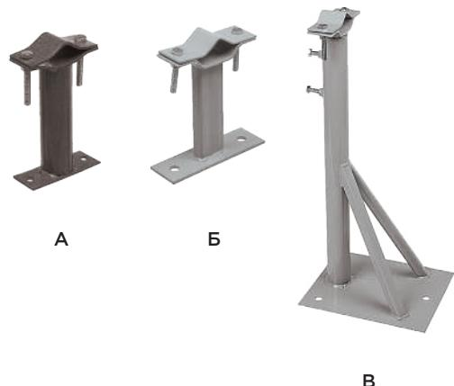
Кронштейны закрепляют мачту молниеприемную наружным диаметром от 30 до 90 мм на фасаде зданий, а также на других вертикальных поверхностях. Для крепления на фасаде зданий кронштейны имеют фланец с отверстиями диаметром 12 мм.
