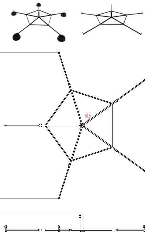
Основание позволяет установить мачту молниеприемную серии СМТ на плоской кровле, либо твердых поверхностях. Возможно использование как с бетонными утяжелителями, так и без утяжелителей. В качестве утяжелителей используется бетонное основание для молниеприемника 16 мм массой 28 кг. Для крепления токоотвода в комплектацию включен зажим под пруток диаметром 8-10 мм.
