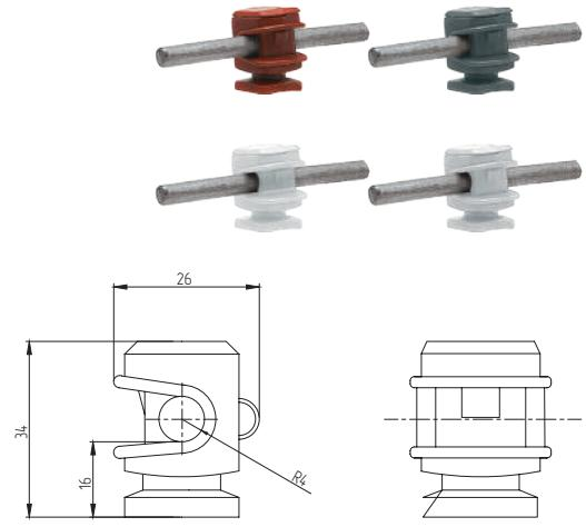
Держатели выполнены из пластика и закрепляют пруток молниезащитной сетки диаметром 6-8 мм на кровле и/или фасаде здания. Расстояние от прутка до основания держателя составляет 16 мм. В основании держателя имеется отверстие для крепления при помощи винта (самореза).
