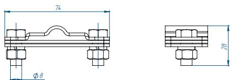
Зажим позволяет выполнить соединение в параллельном направлении полосы шириной до 40 мм и прутка 8-10 мм. Зажим стягивается болтами с гайками M8.
