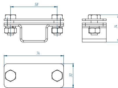
Держатель выполнен из оцинкованной стали и позволяет закрепить полосу шириной до 40 мм на горизонтальных и вертикальных поверхностях. Зажим стягивается болтами с гайками M8. Для крепления держатель имеет отверстие диаметром 8,4 мм под винт либо саморез.
