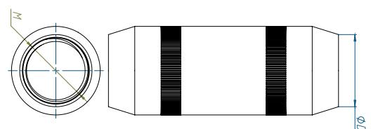
Муфта выполнена из латуни и применяется для соединения омедненных стержней заземления диаметром от 14 до 20 мм между собой. Изделие имеет резьбу от M16 до M22 соответственно. Рифление на наружной стороне обеспечивает удобство сборки. При монтаже стержни заземления соприкасаются друг с другом в центре муфты, благодаря чему ударный импульс не «рассеивается» и с муфтой снимается механическая нагрузка.
