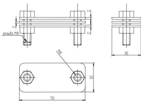
Зажим позволяет выполнить соединение в параллельном направлении полосы шириной до 40 мм. Зажим стягивается болтами с гайками M8.
