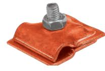
Держатели закрепляют пруток молниезащитной сетки диаметром 6-10 мм на стоячем плоском фальцевом шве фальцевой кровли шириной от 0,7 до 3 мм. Пластины с пазами под фальц кровли прижимаются к основе держателя болтами с гайками M8.
