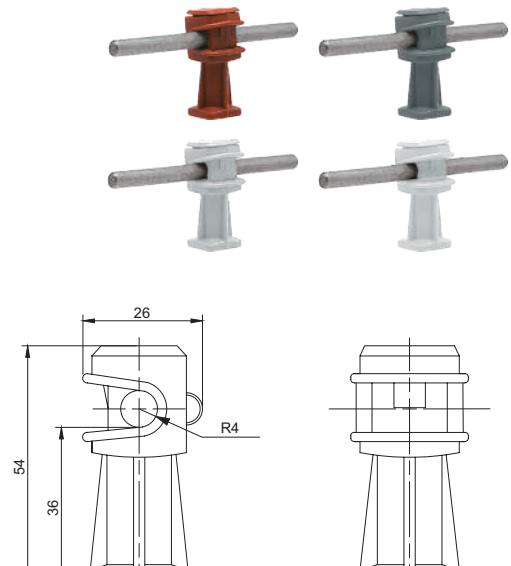
Держатели выполнены из пластика и закрепляют пруток молниезащитной сетки диаметром 6-8 мм на кровле и/или фасаде здания. Расстояние от прутка до основания держателя составляет 36 мм. В основании держателя имеется отверстие для крепления при помощи винта (самореза).
