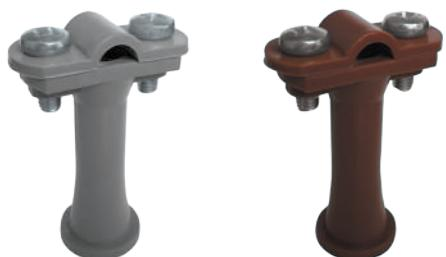
Держатели выполнены из пластика и позволяют закреплять пруток молниезащитной сетки диаметром 6-10 мм. Проток возможно зафиксировать на кровле и на фасаде здания. Расстояние от прутка до основания держателя составляет 59 мм. В основании держателя имеется отверстие с резьбой M8 для крепления при помощи шпильки, а также винта (самореза). Проток закрепляется при помощи винтов M6.
