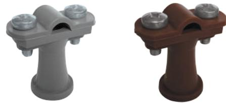
Держатели выполнены из пластика и позволяют закреплять пруток молниезащитной сетки диаметром 6-10 мм. Проток возможно зафиксировать на кровле и на фасаде здания. Расстояние от прутка до основания держателя составляет 38 мм. В основании держателя имеется отверстие с резьбой M8 для крепления при помощи шпильки, а также винта (самореза). Проток закрепляется при помощи винтов M6.
