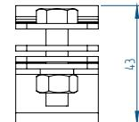
Держатель выполнен из оцинкованной стали и позволяет выполнить переход из полосы на пруток в параллельном направлении, а также соединить прутки либо полосы в параллельном направлении на горизонтальных и вертикальных поверхностях. Зажим стягивается болтами с гайками M8. Для крепления держатель имеет отверстие диаметром 8,4 мм под винт либо саморез.
