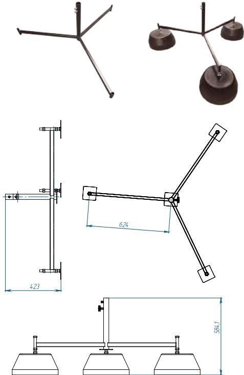
Основание позволяет установить мачту молниеприемную серии СММ и СМТ на плоской кровле, либо твердых поверхностях. Возможно использование как с бетонными утяжелителями, так и без утяжелителей. В качестве утяжелителей используется бетонное основание для молниеприемника 16 мм массой 28 кг. Для крепления токоотвода в комплектацию включен зажим под пруток диаметром 8-10 мм.
