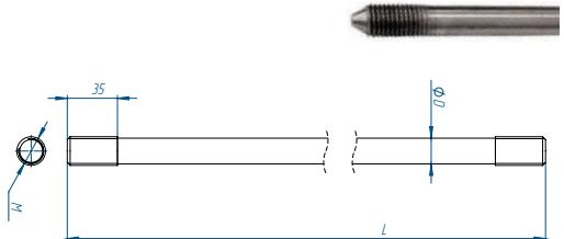
Стержни заземления представляют собой круглый стальной проводник с резьбой на концах. Изделия выполнены из нержавеющей стали, благодаря чему имеют устойчивость к химическим, термическим и механическим воздействиями.
