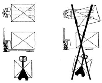
Груз должен располагаться так, чтобы вес равномерно распределялся на обе вилы.
