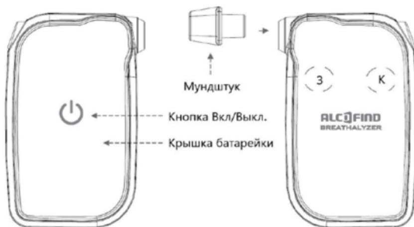
Корпус прибора прикрыт двумя белыми крышками. Одна из них – с нанесенным на нее символом кнопки включения/выключения выполнена съемной и служит крышкой батарейного отсека, под второй, с нанесённым наименованием торговой марки Alcofind, расположены
