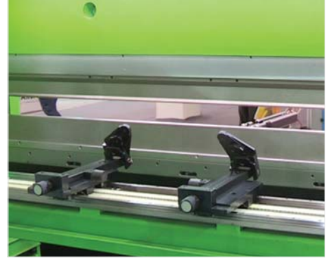
■ 4 eksen (X, R, Z1, Z2) Servo motorlu arka dayama istenilen geometriye göre 0,05 mm pozisyonlama hassasiyetine sahip arka dayama (S)
