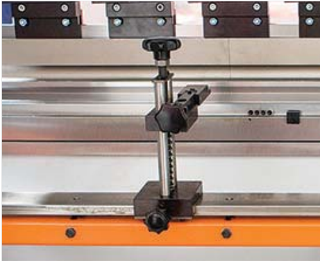
■ Özel tasarlanmış katlanabilir arka dayama dilleri (S)
