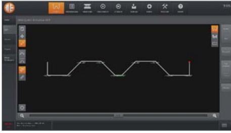
■ Kontrol ekranında 2B parça çizimi yapılabilir
