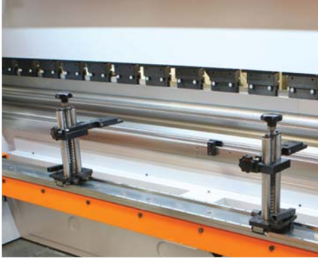
■ Power-Bend Pro standart arka dayama sistemi X eksenli motorlu, R eksenli manuel hareketli olarak sunulmaktadır (S)
