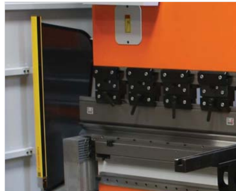
■ Güvenli çalışmayı sağlayan CE standartlarına uyumlu vücut koruma ışık perdesi (S)
