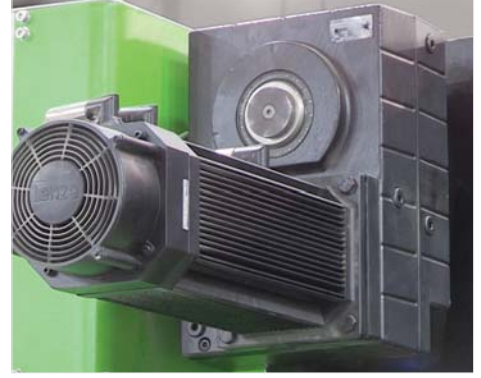
■ Yüksek verimli senkron ac servo motorlar ile üst çene hareket ettirilir (S)
