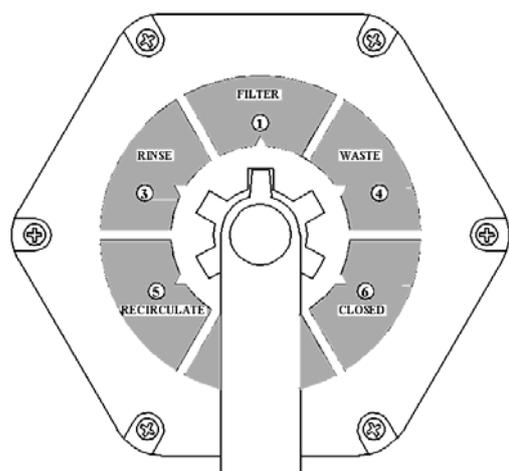
**В режиме промывки** фильтра схема движения воды выглядит следующим образом: вода из ванны подается насосом в фильтр, далее проходит обратным потоком через фильтр (снизу вверх) и сбрасывается в канализацию. При промывке фильтра, для избежания завоздушивания и выхода из строя (поломки) насоса, забор воды рекомендуется осуществлять через донные сливы ванны бассейна. В режиме промывки фильтра положение ручки вентиля показано на рисунке 6.
