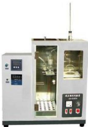
Этот прибор разработан и изготовлен в соответствии с промышленным стандартом SH / Т 0165-92 Метод определения характеристик дистилляции нефтепродуктов с высокой температурой кипения Вакуумный процесс. Подходит для определения характеристик дистилляции воскового масла, смазки масла и другие нефтепродукты с высокой температурой кипения.
