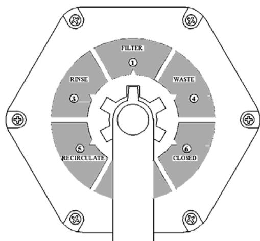
**В режиме промывки** фильтра схема движения воды выглядит следующим образом: вода из ванны подается насосом в фильтр, далее проходит обратным потоком через фильтр (снизу вверх) и сбрасывается в канализацию. При промывке фильтра, для избежании завоздушивания и выхода из строя (поломки) насоса, забор воды рекомендуется осуществлять через донные сливы ванны бассейна. В режиме промывки фильтра положение ручки вентиля показано на рисунке 6.
