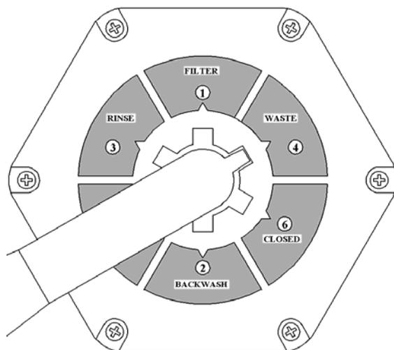
В режиме рециркуляции схема движения воды выглядит следующим образом: вода из ванны забирается насосом фильтровальной установки, минуя фильтр, возвращается в бассейн. В режиме рециркуляции положение ручки вентиля показано на рисунке 9.
