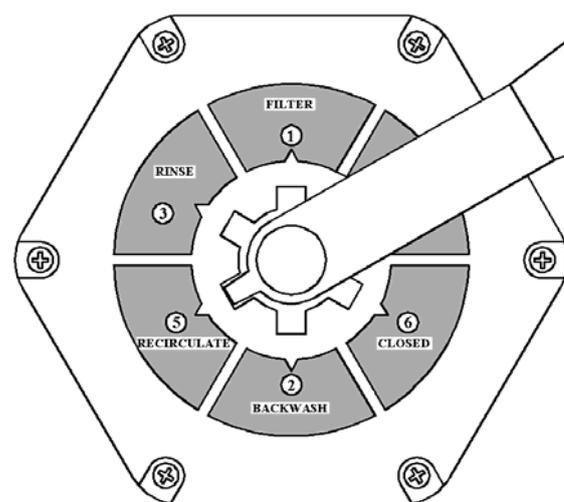
В режиме CLOSED 6-ти поз. вентиль закрыт. Движение жидкости через 6-ти поз. вентиль не осуществляется. В режиме CLOSED положение ручки вентиля показано на рисунке 10.
