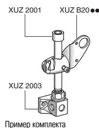
Кронштейн с шарниром для цилиндрических датчиков
