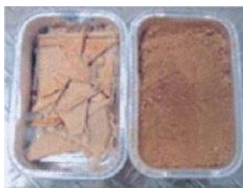
Линолеум: 50-мл стальной сосуд, 20-мм стальные шарики – измельчение до 200 мкм за 60 секунд
