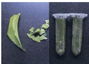
Листва: переходник с микрососудами, 3-мм шарики из карбида вольфрама в каждом сосуде. Полная гомогенизация.
