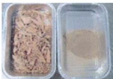
Дерево: 50-мл стальной сосуд, 20-мм стальные шарики – измельчение до 200 мкм за 90 секунд
