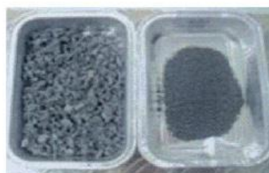
Резина: 20-мл стальной сосуд / 20-мм стальные шарики – вид после криогенного измельчения.
