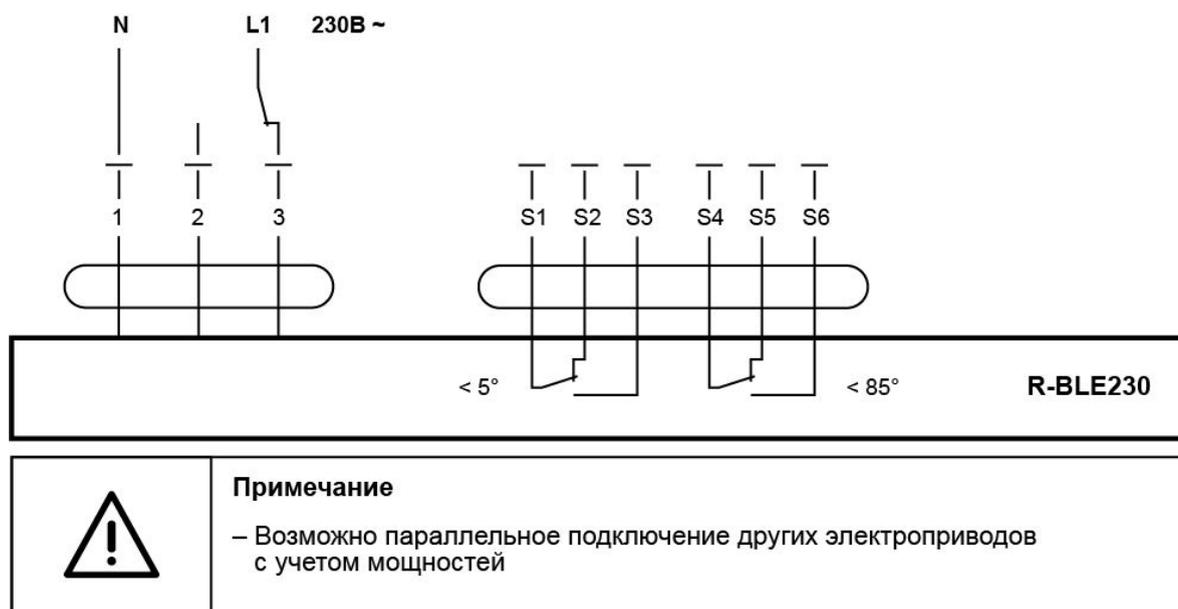
*Примечание: Питание подавать только после установки электропривода на вал заслонки.*
