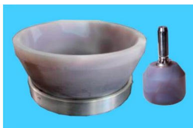
Установка размольной гарнитуры в ступку MG100
