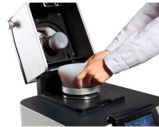
Установка размольной гарнитуры в ступку MG200
