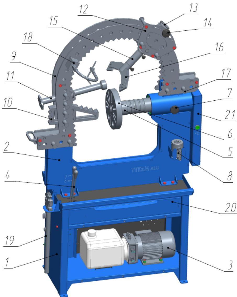
Рисунок 4.1 - Устройство стендса для правки автомобильных дисков
