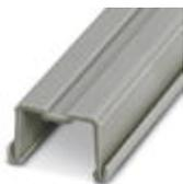
Защитный профиль, для закрытия клеммных групп, устанавливается на опорную рейку АРТ-МЕ или концевой держатель АРН-МЕ. Опорные рейки устанавливаются с обоих концов колодки на расстоянии прибл. 40 см. Длина указывается при заказе.
