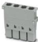
Корпус соединителя, номинальное напряжение: 250 В, номинальный ток: 10 А, тип подключения: Штекерное подключение, количество точек подсоединения: 4, полюсов: 4, сечение: 0,5 мм<sup>2</sup> - 2,5 мм<sup>2</sup>, AWG: 20 - 14, ширина: 5,2 мм, высота: 13 мм, цвет: серый, тип монтажа: Штекерный монтаж
