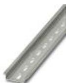
DIN-рейка, с перфорацией, Стандартный профиль, ширина: 35 мм, высота: 7,5 мм, согласно EN 60715, материал: Сталь, оцинкован., пассивирован., длина: 2000 мм, цвет: серебристый
