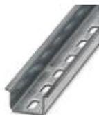
DIN-рейка, с перфорацией, Стандартный профиль, ширина: 35 мм, высота: 15 мм, соотв. EN 60715, материал: Сталь, оцинкованный, длина: 2000 мм, цвет: серебристый
