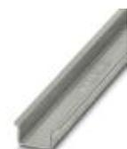
Несущая рейка без перфорации, Стандартный профиль 2,3 мм, ширина: 35 мм, высота: 15 мм, согласно EN 60715, материал: Сталь, оцинкован., пассивирован., длина: 2000 мм, цвет: серебристый
