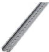
DIN-рейка, с перфорацией, Стандартный профиль, ширина: 35 мм, высота: 7,5 мм, согласно EN 60715, материал: Сталь, оцинковка, белая пассивация, длина: 2000 мм, цвет: серебристый
