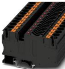
Клеммы для установки предохранителей, тип предохранителя: Плоский, тип подключения: Зажимы Push-in, сечение: 0,5 мм<sup>2</sup>- 16 мм<sup>2</sup>, AWG: 20 - 6, номинальный ток: 30 А, номинальное напряжение: 400 В, ширина: 10,2 мм, тип предохранителей: С, тип монтажа: NS 35/7,5, NS 35/15, цвет: черный
