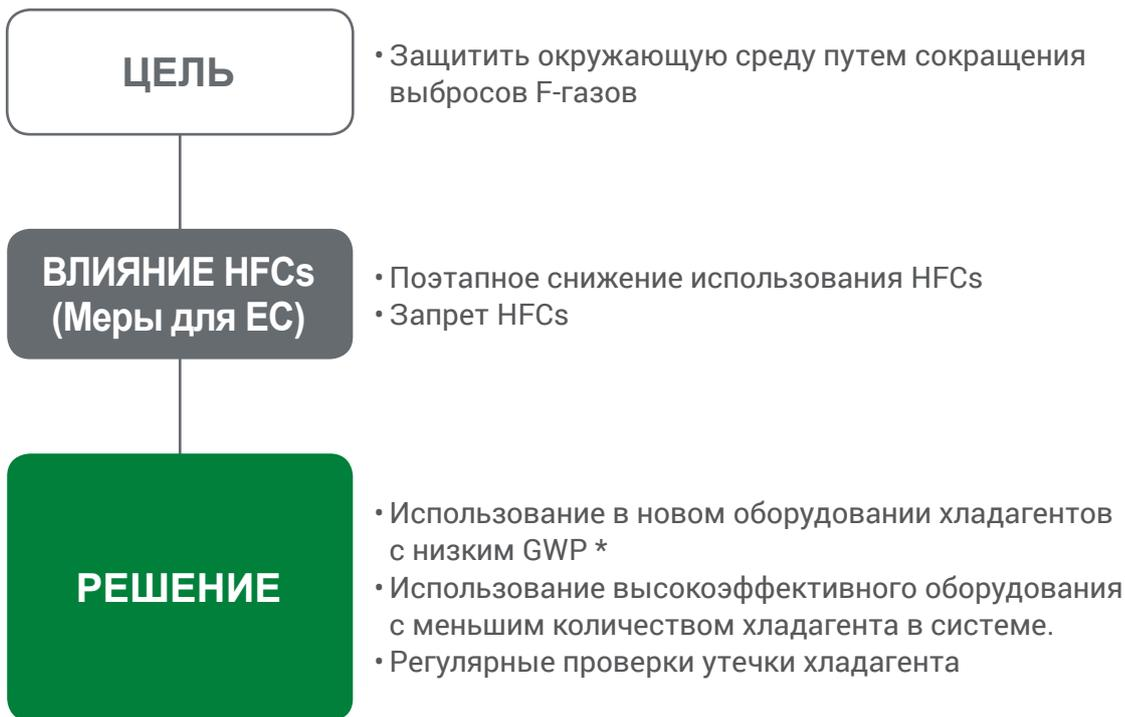
\* GWP (Global Warming Potential – Потенциал воздействия на глобальное потепление). GWP показывает сколько тепла задерживают парниковые газы. GWP – отношение количества тепла, задержанное определенной массой газа к количеству тепла задерживаемому двуокисью углерода, такой же массы. GWP рассчитывается в интервале сто лет.
