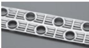
Оптимизация расположения медных трубок и формы оребрения позволила уменьшить сопротивление воздушного потока. Эффективность теплообменника повышена на 33%. Новая форма оребрения обеспечивает одновременно максимальный расход воздуха, минимальное сопротивление и высокий уровень теплосъема.
