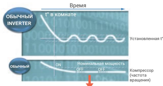
Менее передовая технология не регулирует циклы ВКЛ/ВЫКЛ.
