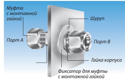
При монтаже фитинга с монтажной гайкой с помощью фиксатора для монтажа на панель один человек может затянуть контргайку, находясь у панели со стороны А. После этого, трубки могут быть подсоединены к сторонам А и В силами одного человека с помощью одного гаечного ключа, поскольку фиксатор играет роль придерживающего ключа.
